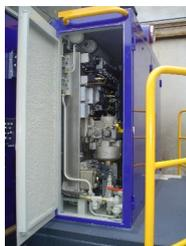
Bremsgerätetafel im eingebauten Zustand in einer Lok
